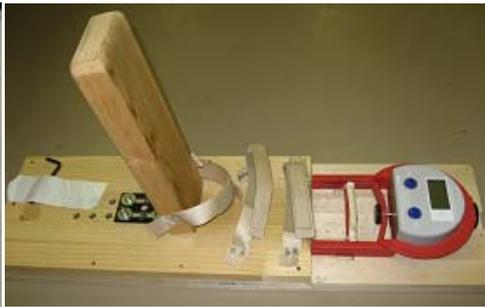
写真3 足趾筋力測定器
