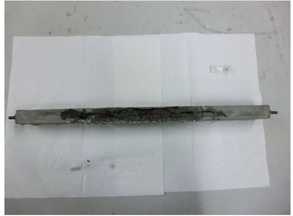
写真 20 : No.IXの腐食ひび割れの様子
