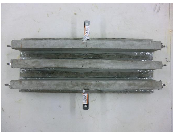
写真 36 :連結桁 A のひび割れ状況
