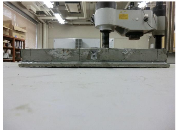
写真 38 :連結桁 C のひび割れ状況
