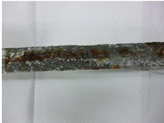
写真 17 : No.Vの腐食ひび割れの様子
