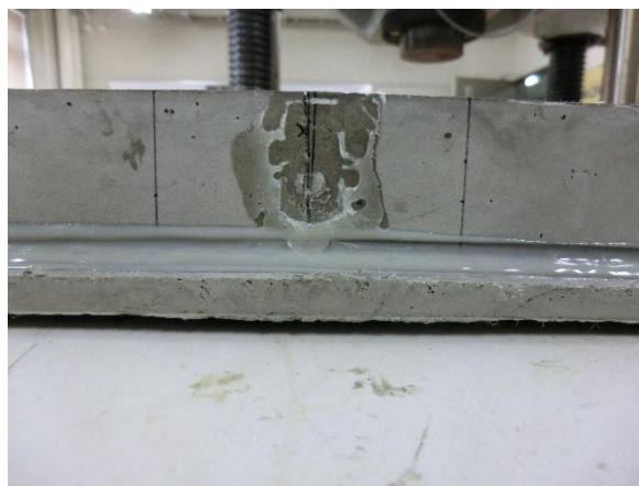
写真 36 :連結桁 A のひび割れ状況
