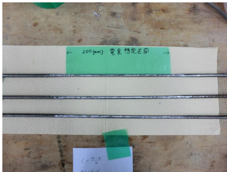
写真9：切削した鉄筋
