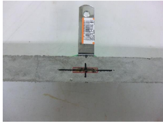
写真 25 : No.③のひび割れ状況
