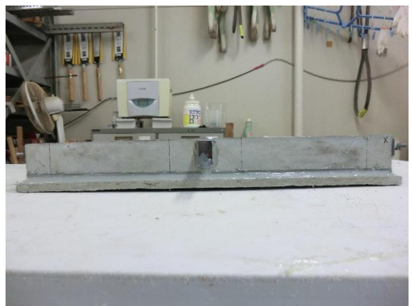
写真 39 :連結桁 D のひび割れ状況
