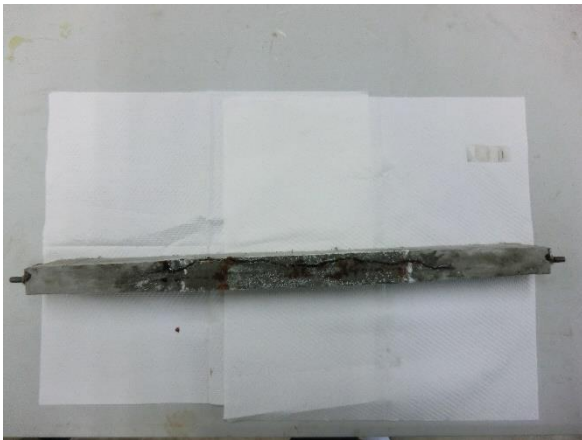
写真 21 : No.XIの腐食ひび割れの様子
