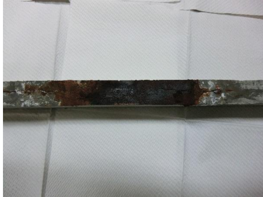
写真 16 : No.IVの腐食ひび割れの様子
