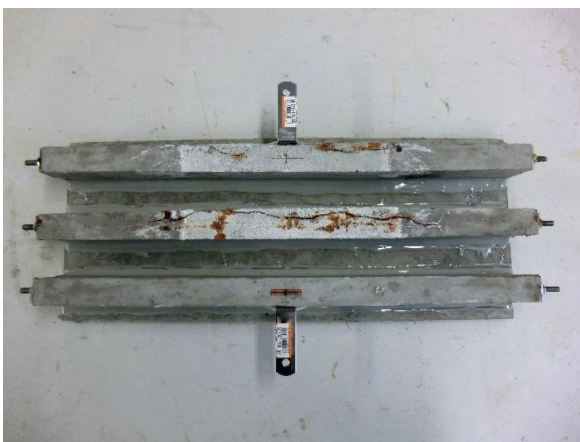
写真 39 :連結桁 D のひび割れ状況
