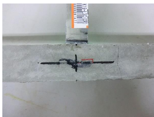
写真 24 : No.②のひび割れ状況
