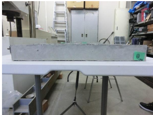
写真 26 : No.④のひび割れ状況
