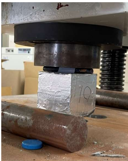
写真-8 万能試験機による試験体の割裂
