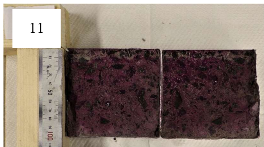
写真-10 フェノールフタレイン溶液を噴射した試験体(試験体番号 9~11)
