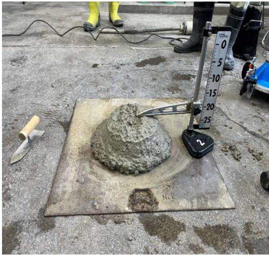
写真-1 スランプ高さの測定
