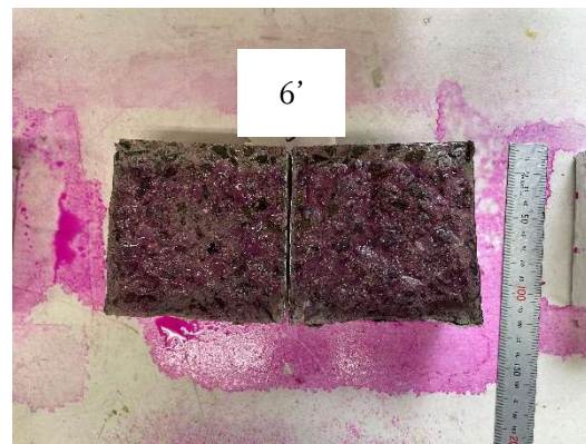
写真-11 フェノールフタレイン溶液を噴射した試験体(試験体番号1'～6')
