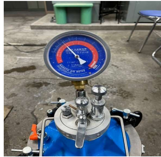
写真-2 コンクリートの空気量
