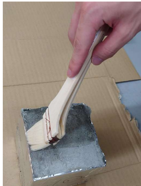
写真-4 含浸剤を塗布している様子
