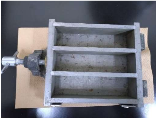
写真-13 試験体作製に使用した型枠
