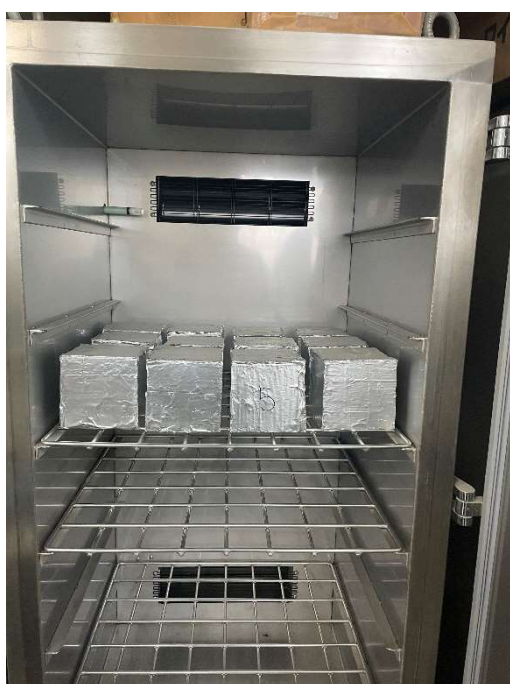
写真-6 中性化試験装置に試験体を設置
