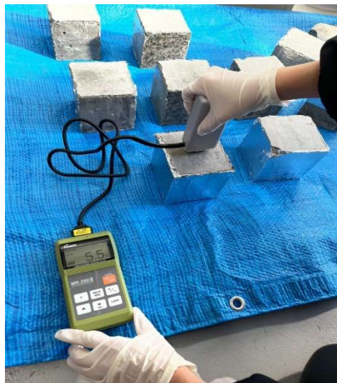
写真-5 表面含水率の測定
