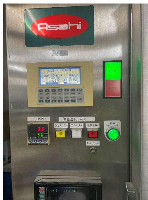
写真-7 中性化試験装置の設定
