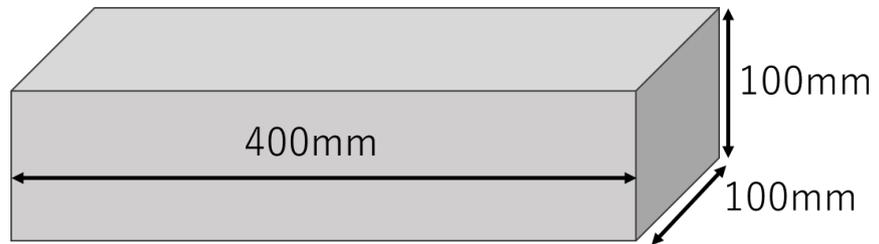
曲げ強度試験用無筋コンクリート梁
