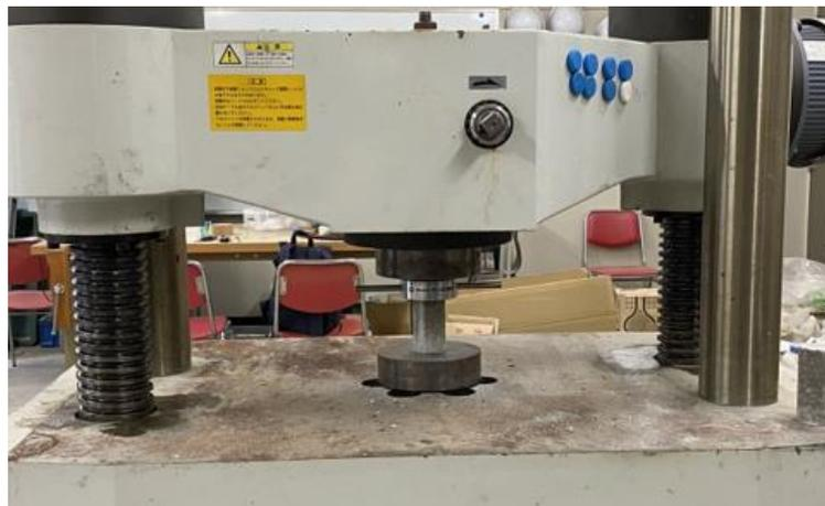
写真 5 圧縮強度試験の様子
