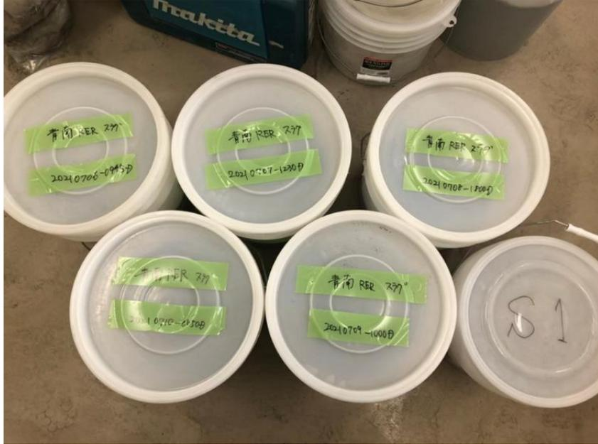
写真 3 砂およびスラグの保管方法
