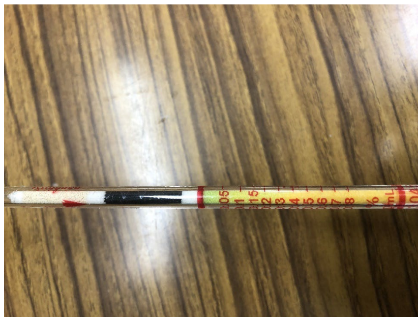
図 78.水 4 滴の水素の濃度
