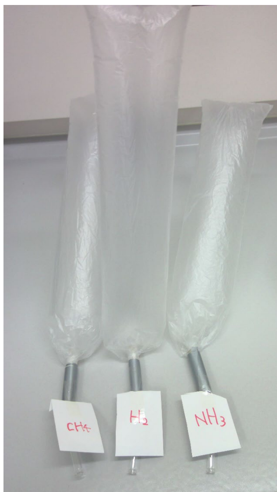
図 108.メタン,水素,アンモニアを封入した傘袋 左からメタン,水素,アンモニア
