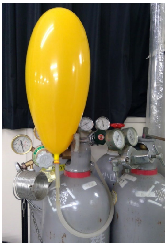
図 32. ゴム風船にガスポンベからメタンガスを封入
