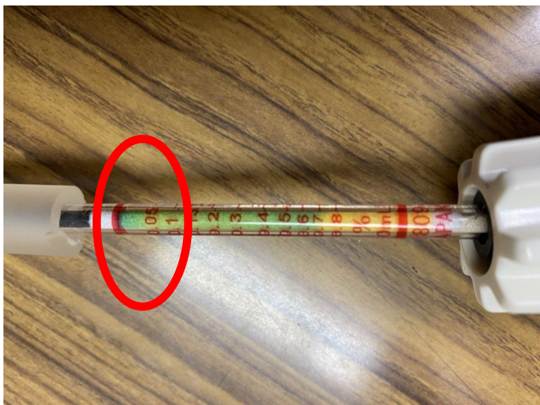
図 70.1 回目の実験の水素検知管
