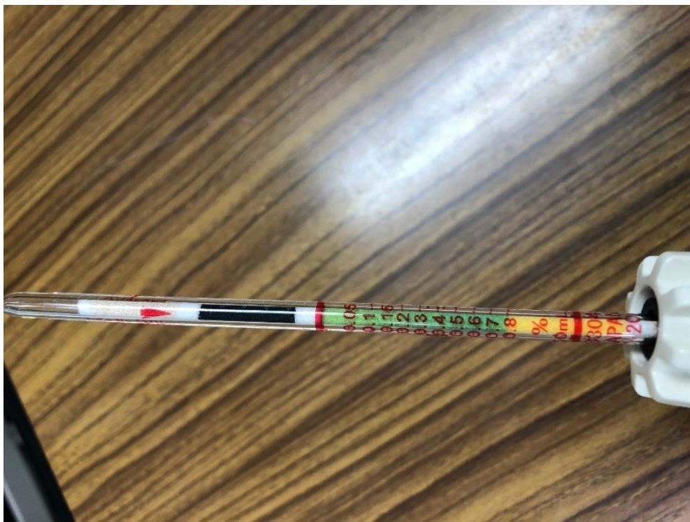
図 82. ガスバーナーを2つ用いた実験の水素濃度
