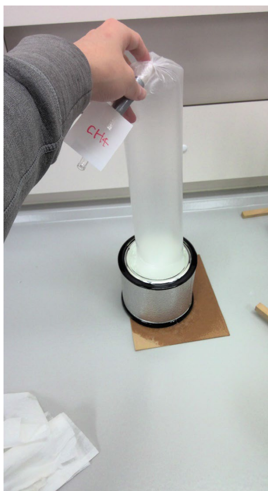
図 109.ドライアイスを用いた冷却
