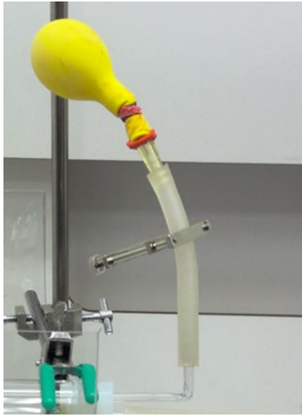
図 68.ゴムチューブ上のピンチコック
