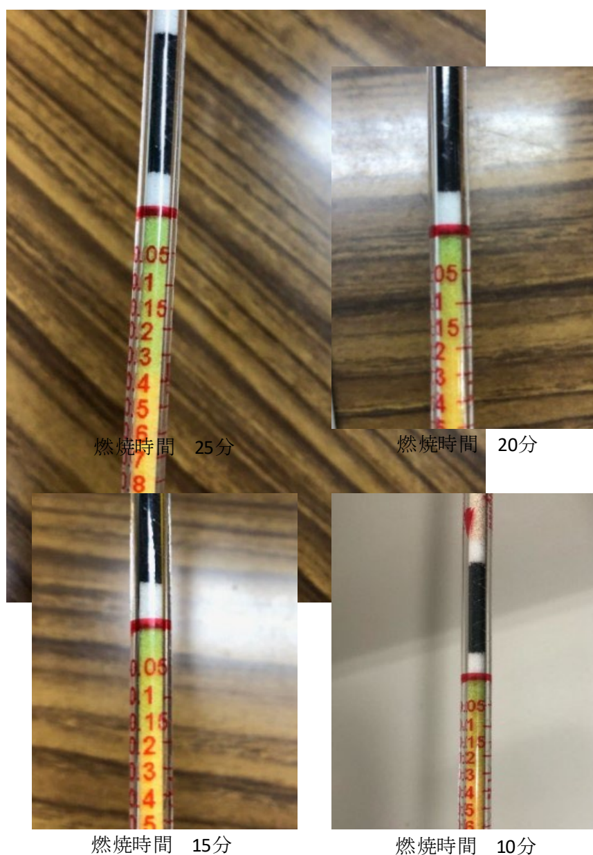
図 76.各燃焼の時間における水素濃度
