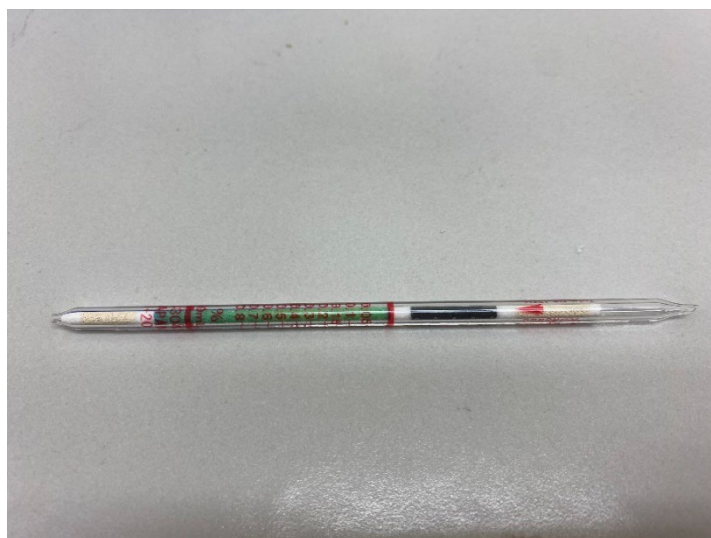
図 114.5 回目の水素検知管
