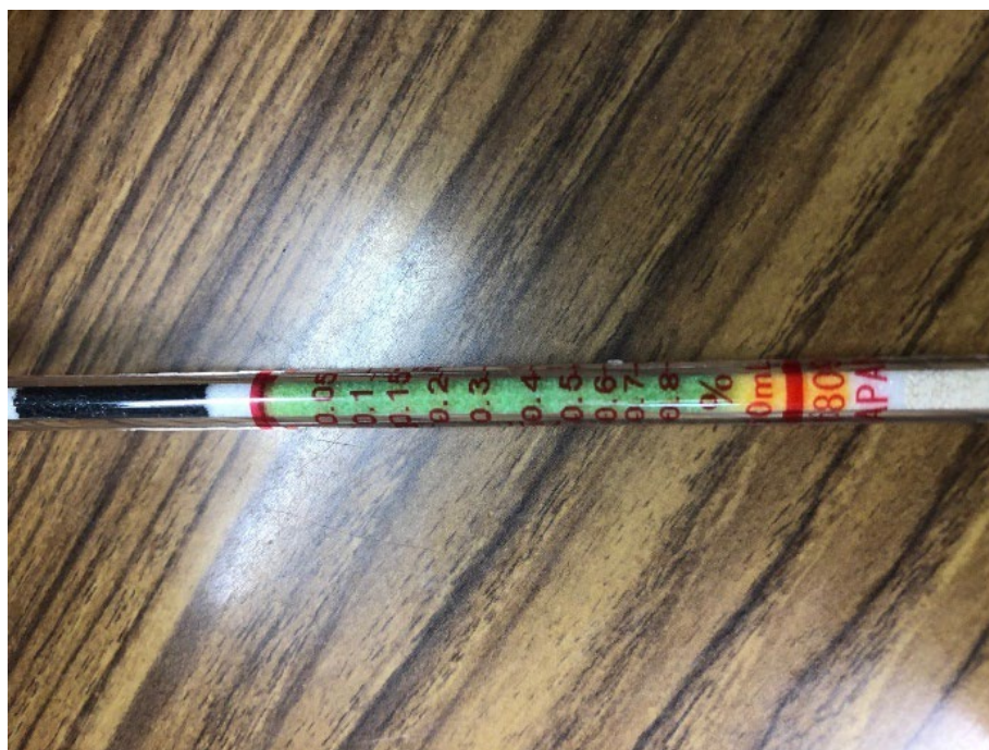
図 71.3 回目の実験の水素検知管
