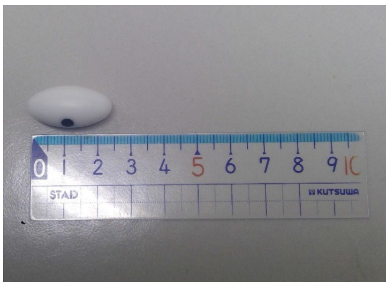
図 23. 攪拌時に用いたオーバル型の強力攪拌子 横の長さが 25mm, 縦の長さ 12mm.
