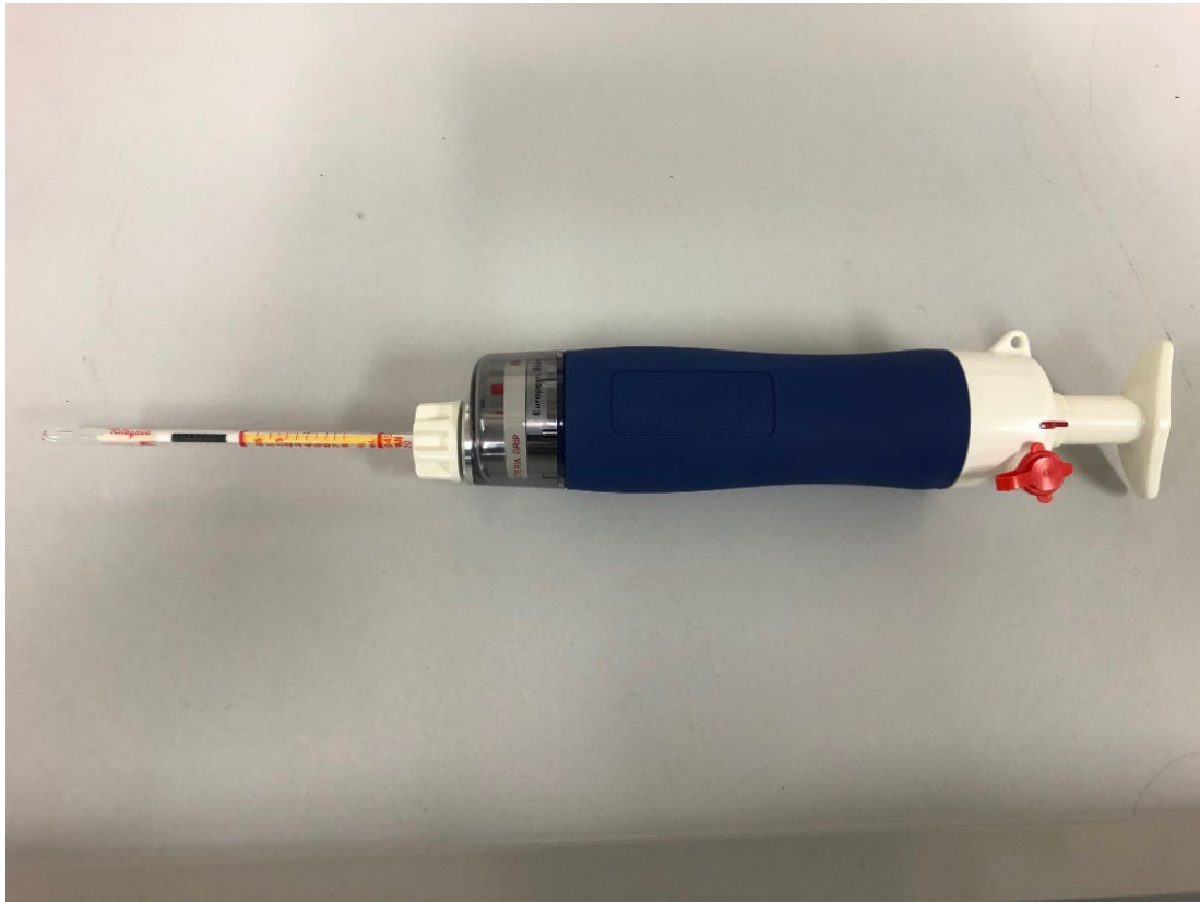
図 63.ガス採取器と水素検知管(取付後)
