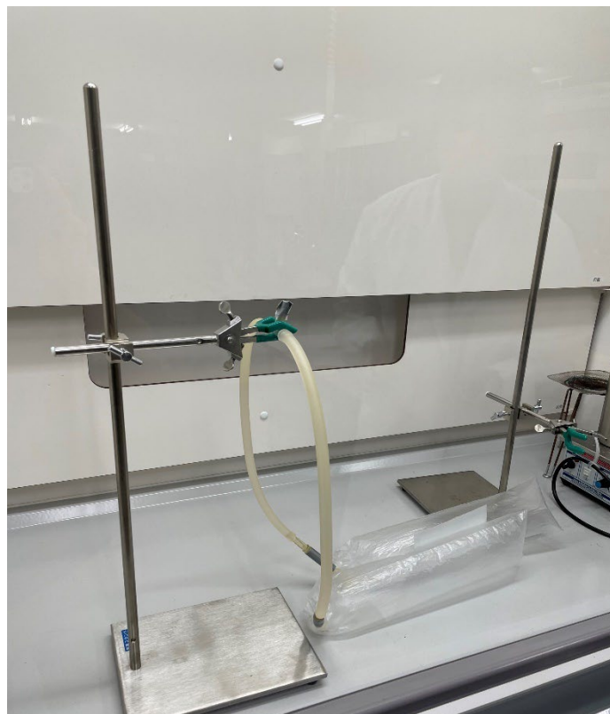
図 104.燃焼継続の実験装置
