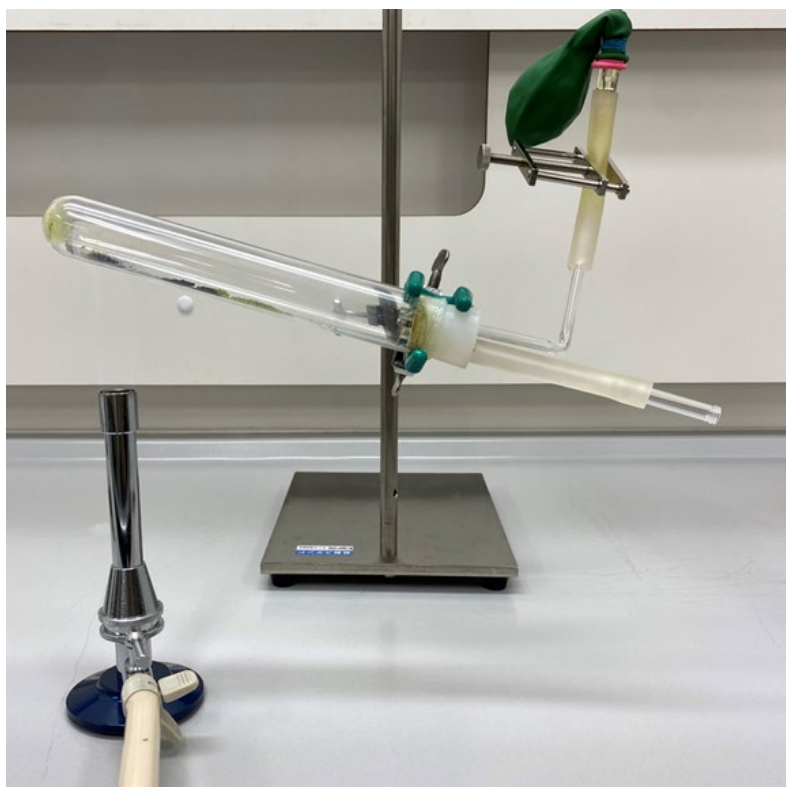
図 113.本実験で組み立てたアンモニア熱分解装置
