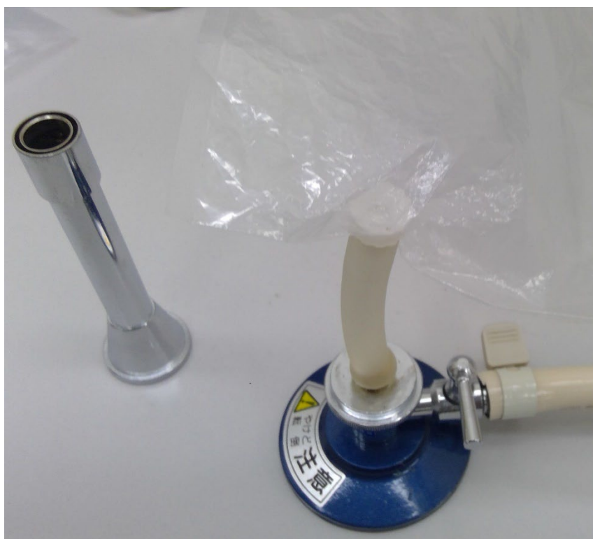
図 41.ガスバーナーを用いた都市ガスの採集
