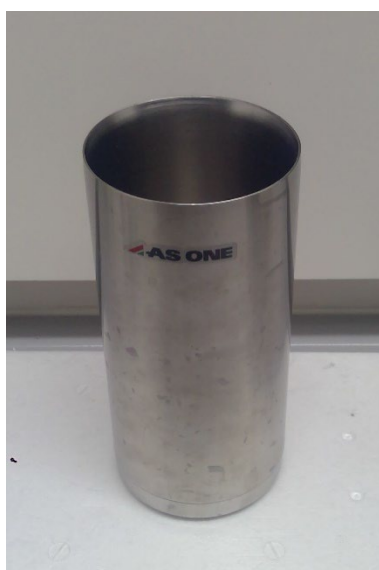
図 24. 液体窒素冷却時に使うデュワー
