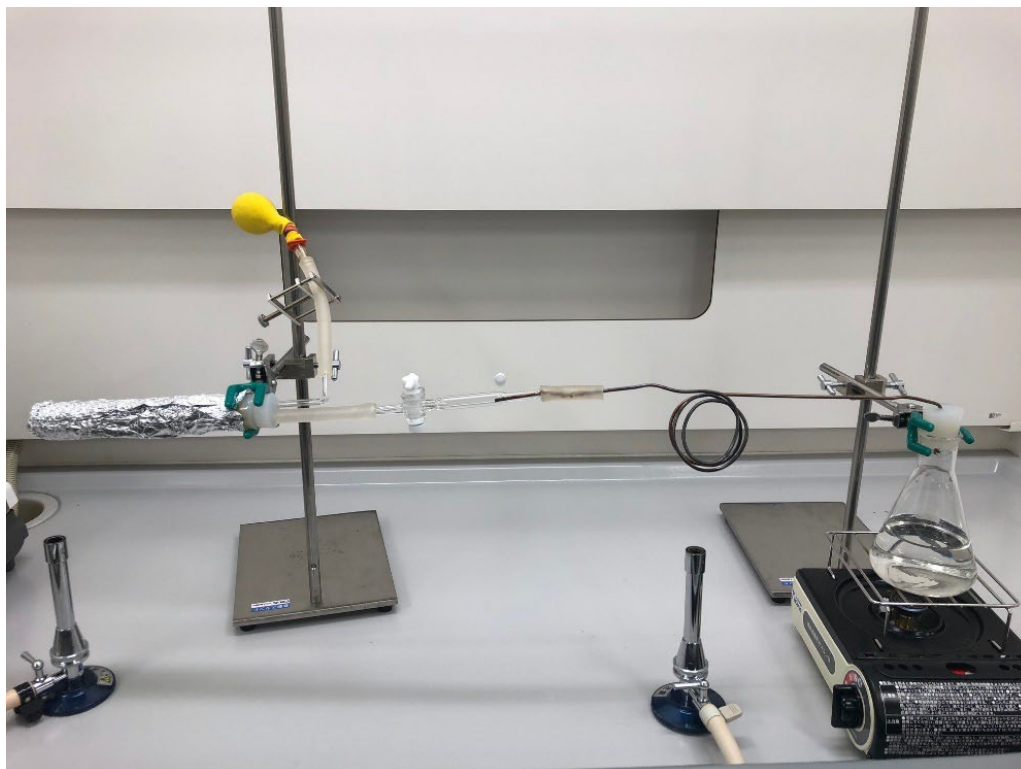
図 83.試験管にアルミホイルを巻いた生成実験
