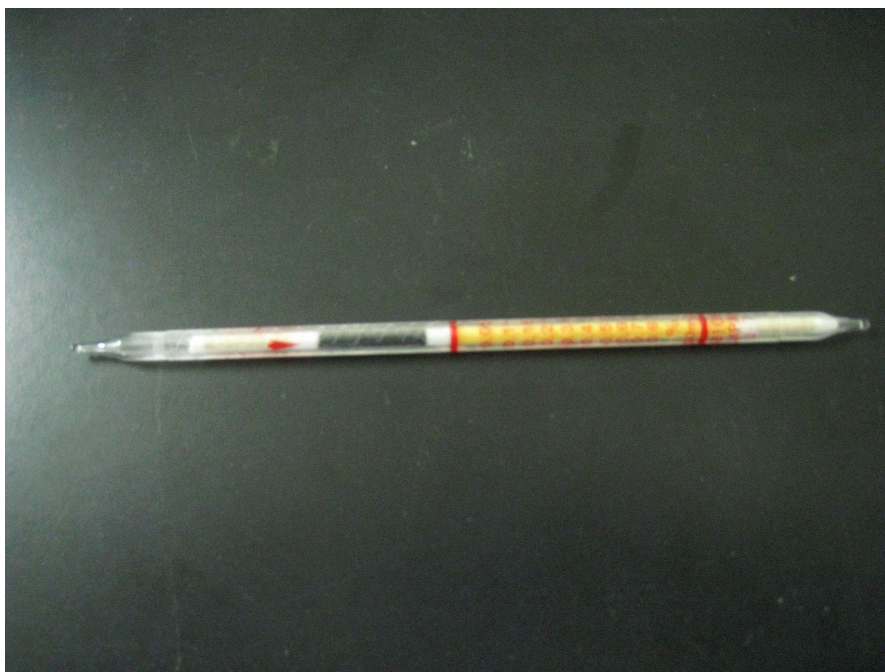
図 60.北川式ガス検知管【水素】 実際に使用したもの
