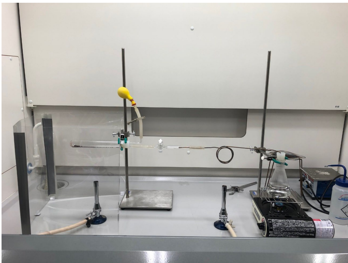
図 65.本実験で組み立てた水蒸気改質装置
