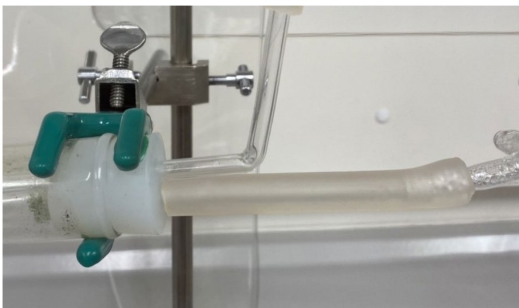
図 67. クランプでゴム栓を挟む
