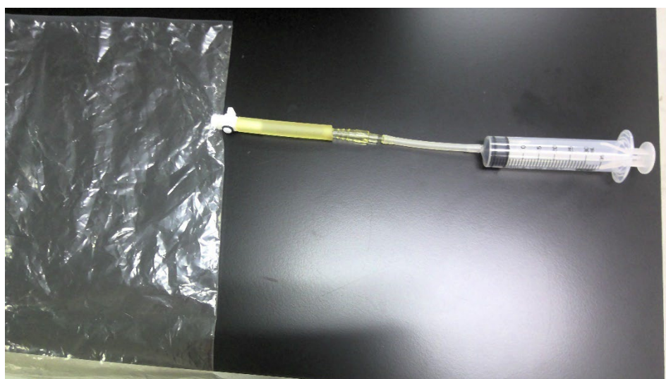
図 96.テドラーバッグから気体の採取
