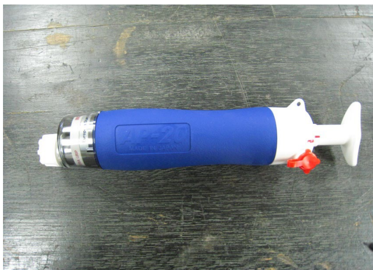
図 62.ガス採取器(取付前)
