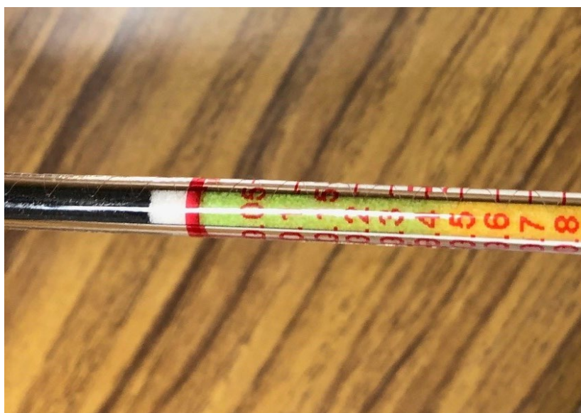
図 79.水 5 滴の水素の濃度
