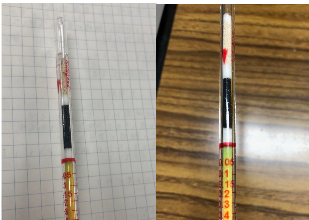
図 84. 燃焼時間 15 分の水素濃度 アルミホイルあり（左）, アルミホイルなし（右）
