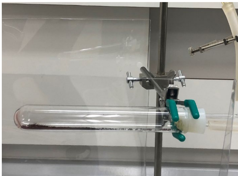
図 74.鉄触媒( \text{Fe}_2\text{O}_3 )を用いた水蒸気改質
