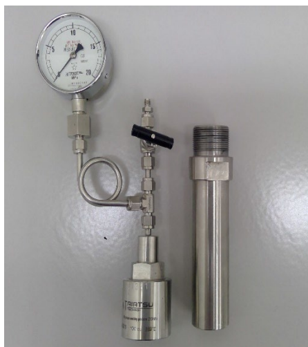
図 27.組み立てる前の圧力容器
