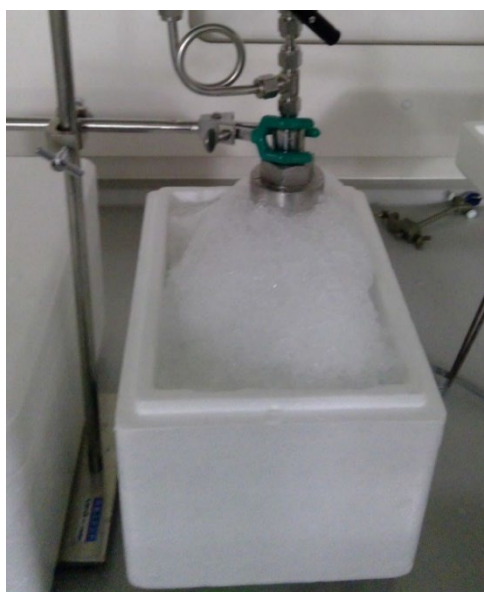
図 35.氷水を用いて 0℃に保って攪拌
