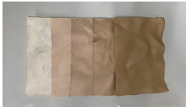
図6 作製した手漉き紙 画像左より秋田スギ由来パルプ混合率 0%, 25%, 50%, 75%, 100%
