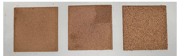
図5 作製したバインダーレスボード 左から粒度0.5mm、1.0mm、2.0mm
