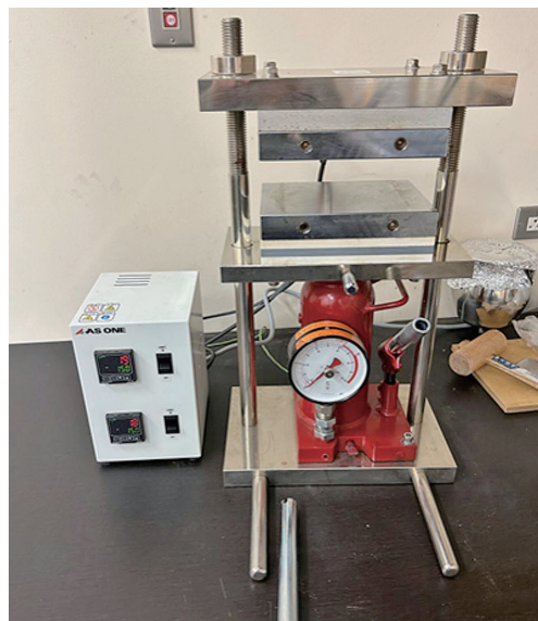
図3 使用した小型熱プレス機
