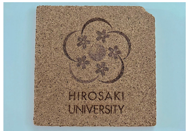
図1 バインダーレスボードを用いた試作品
