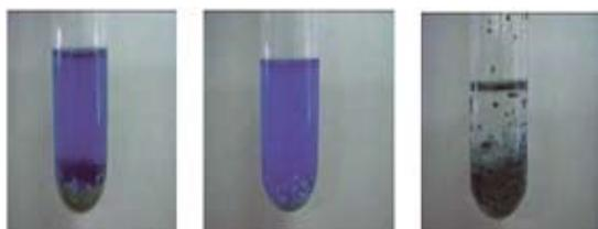
図5 合成したフタロシアニンを溶解させたもの（溶媒は左からメタノール、アセトン、クロロホルム）
