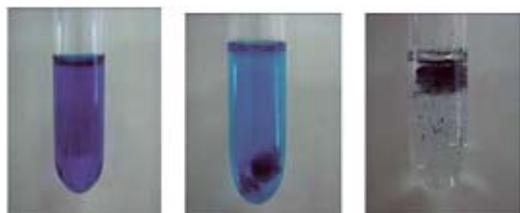
図6 プリンターのインクを溶解させたもの（溶媒は左からメタノール、アセトン、クロロホルム）
