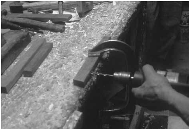
③音の波の節目にあたり振動を妨げない位置に紐を通すための穴をあける
