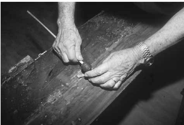
⑮ ゴムの木から板材を切り出し放置しておくで表面に沁み出た樹液が固まり、ゴムの膜ができる。これをガイシシル材の木の棒に巻きつけてマレットをつくる
