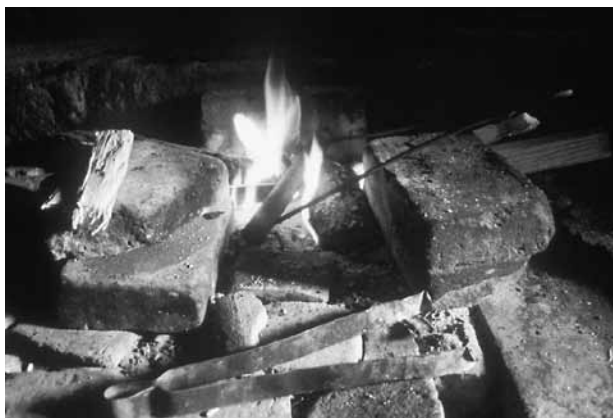
⑦鉄パイプでつくったローラー式のコテを火にかけて熱くする
