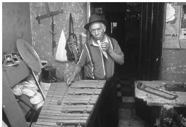
⑩共鳴筒に息を吹き込んで、鍵盤の音程と同じであるか、確認する
