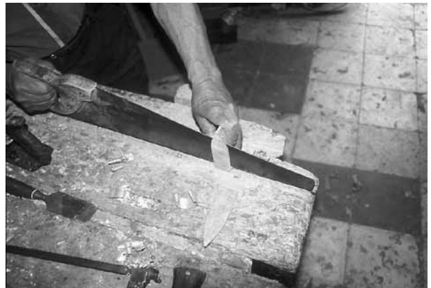
⑥マリンバの丸い音色は、裏側のえぐられた削りとともに、共鳴筒によって得られる。共鳴筒は、マホガニー材の一種セドロでつくられている。角材を流線型に削り、さらに4枚の部材に切り分ける
