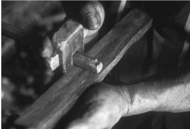
②音板には、高音部にはローズウッド材、中音～低音部はマホガニー材がつかわれる。よく乾燥させた木材を罫引きを使って木取る
