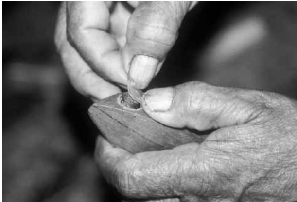
⑬ 共鳴箱の底にあたりに穴をあけ、蜜ロウで盛り上げた上にブタの腸の膜を貼る
