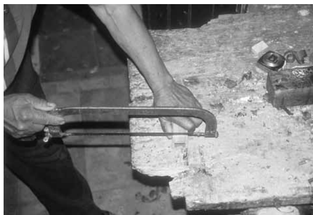
⑪共鳴筒の長さを調節して、音の高さを調節する
