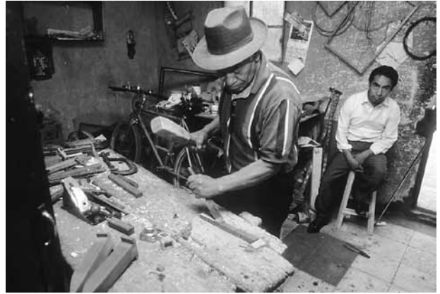
④鍵盤の裏側をノミなどを使ってえぐるように削る。この作業によって倍音が加わりマリンバ独特の丸みのある音色になる
