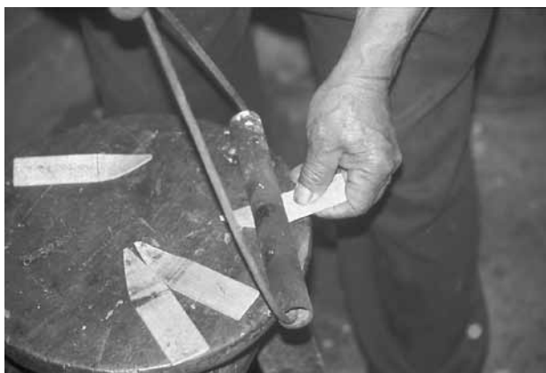
⑧熱したコテを、水で湿した部材にあてて曲面に成形する
