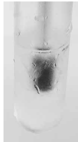
図9 過冷却が破れてシャーベット状になった水
