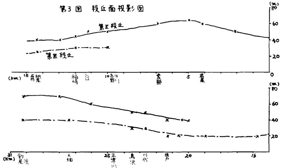
この地域の地盤運動の性質を知るために旧汀線の高度を海岸に平行な断面上に投影した（図3）。旧汀線の高度の変化より量的に地盤運動をとらえた。
