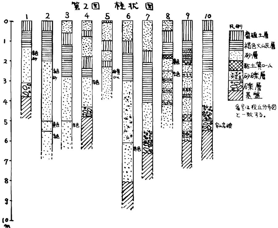
第Ⅰ段丘の野中沼東岸(図2の1)では、基盤と不整合に閃緑岩の礫層(垂円礫で最大径40cm)が60cmあり、その上に酸化された中粒の赤色砂層があり、褐色火山灰層(80cm)、
