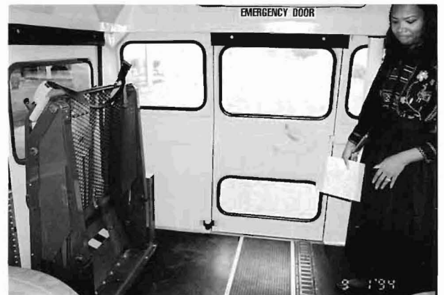
39. スクールバスの内部—車椅子用のリフトと固定具
