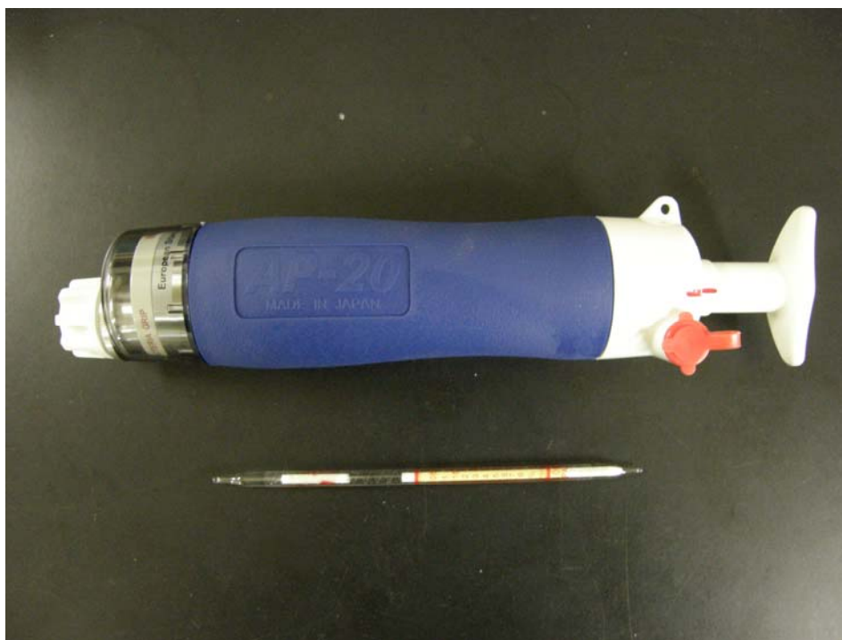
図 3-2 北川式ガス採取機 AP-20(上)、北川式ガス検知官－水素(下)
