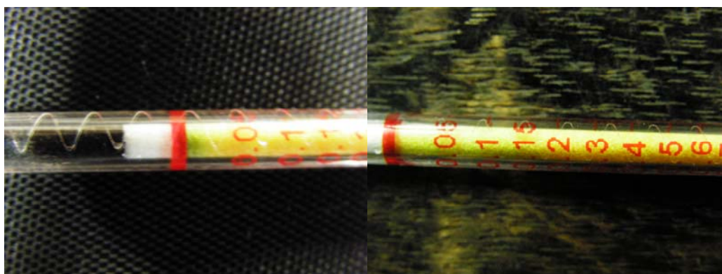
図 3-9 リンゴ搾りかすのみ(左)、リンゴ搾りかすと Ni 触媒の混合物(右)
