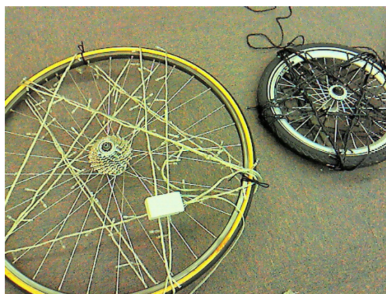
図 1：自転車のホイールに LED を巻き付けて作ったライトアップの飾り
