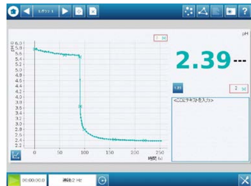
窒素酸化物をフラスコ内の冷水に送り込んだときの pH の変化
