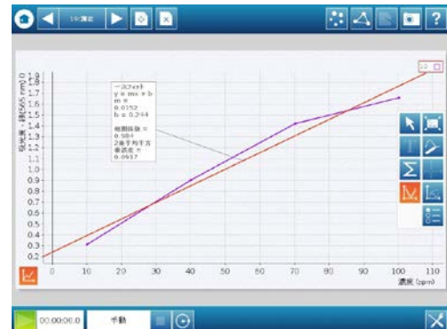
標準溶液の濃度と吸光度の関係（検量線）
