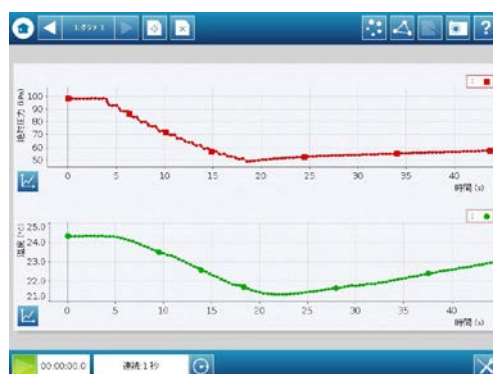
フラスコ内の空気を抜いた時の圧力変化と温度変化
