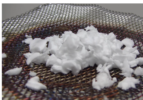
(i) 空気を抜いて生成したメタンハイドレート
