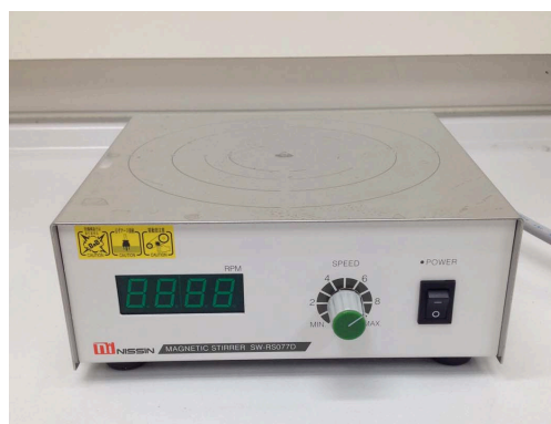
図 15 攪拌に使用したマグネティックスターラ
