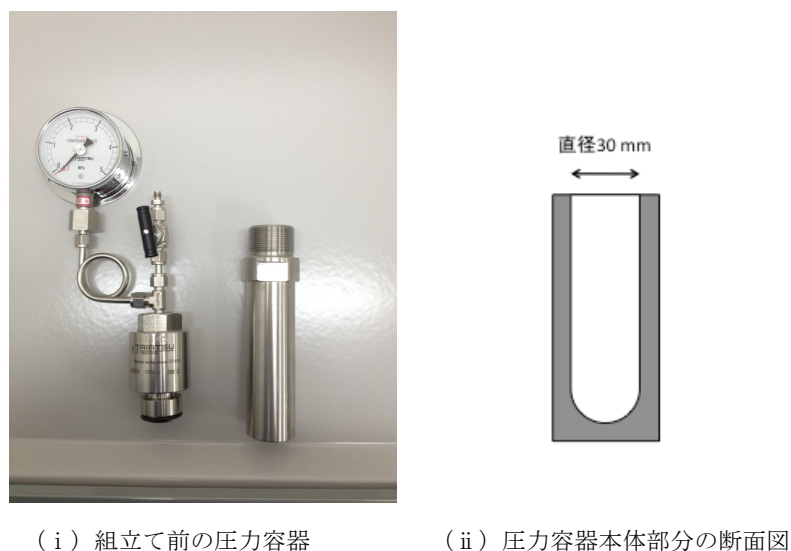
図 16 メタンハイドレートの生成に用いた圧力容器
