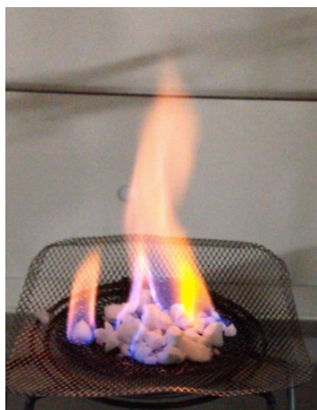
(i) 空気を抜いて生成した場合 炎を上げながら激しく燃焼し、燃焼中はパチパチと音を立てていた。
