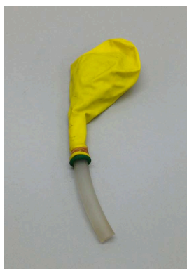
図 12 メタンガスの充鎮に用いたゴム風船 二重にしたゴム風船にゴムチューブを付けて 圧力容器と接続した。
