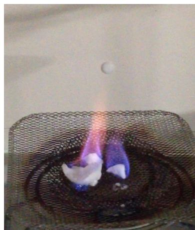
(ii) 空気を抜かずに生成した場合 炎の大きさは大きくなく、シュワシュワと静かに燃焼した。炎の下の部分では、気泡が確認した。
