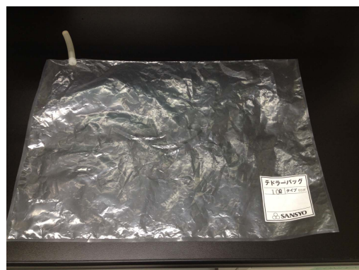
図 13 都市ガスの充鎮に用いたテドラーバッグ 取り出し口にゴムチューブを付けて圧力容器と 接続した。
