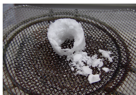
(ii) 空気を抜かずに生成したメタンハイドレート
