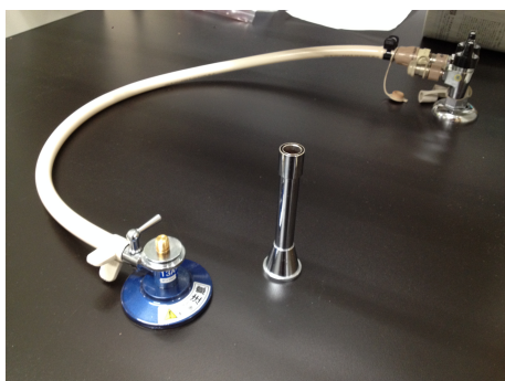
図 38 ガスバーナーのガス調節ネジ部分のみにした様子
