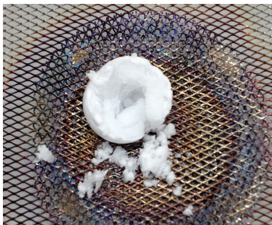
図 41 都市ガスで生成したガスハイドレート 中心部に埋まっている白い固体は、生成時に使用した攪拌子である。
