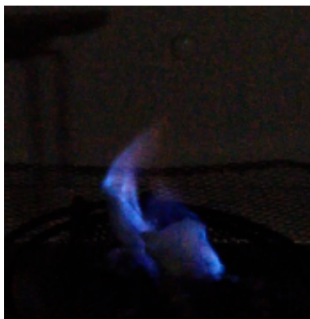
図 47 回転が止まった直後に液体窒素で冷却して取り出したガスハイドレートの燃焼の様子 5.1 の手順で生成した場合と同様，安定した炎の大きさ・形で燃焼した。
