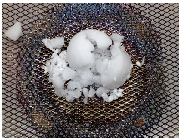
図 46 回転が止まった直後に液体窒素で冷却して取り出したガスハイドレート 透明な部分と白い部分があり、表面が凍っている。
