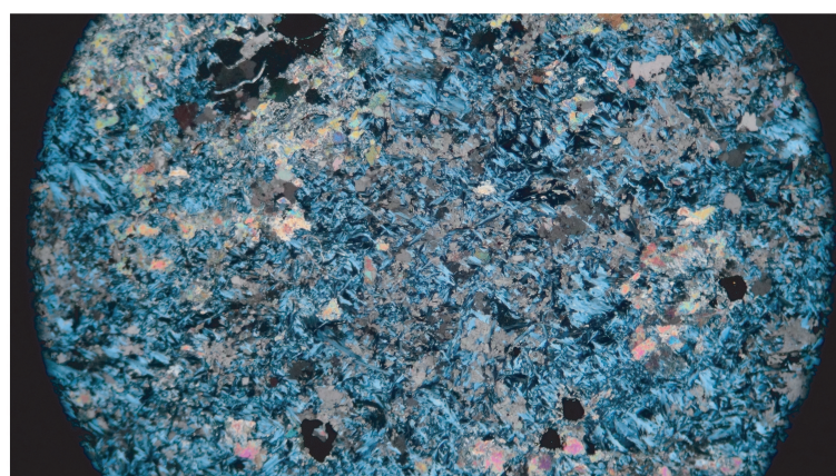
図5.3b 滑石含有型 長辺9.8mm
