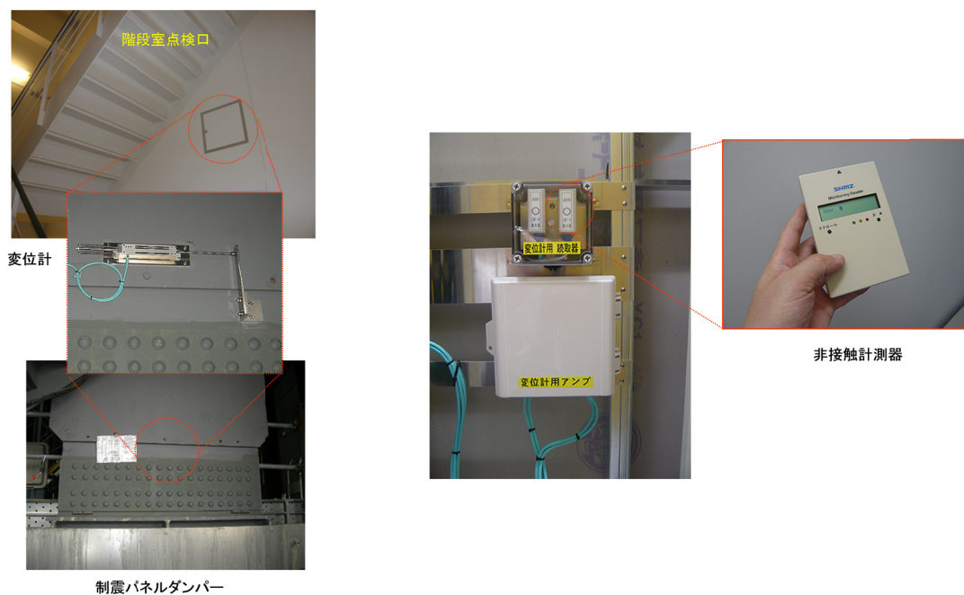
(3) 制震ダンパー（パネル型ダンパー）への変位記憶型センサと非接触計測器の設置
