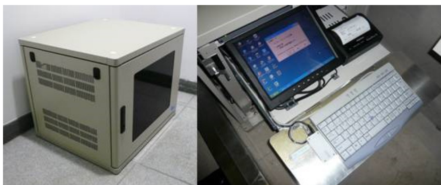
(1) 地震収録装置（収納ラックと内部パソコン）
