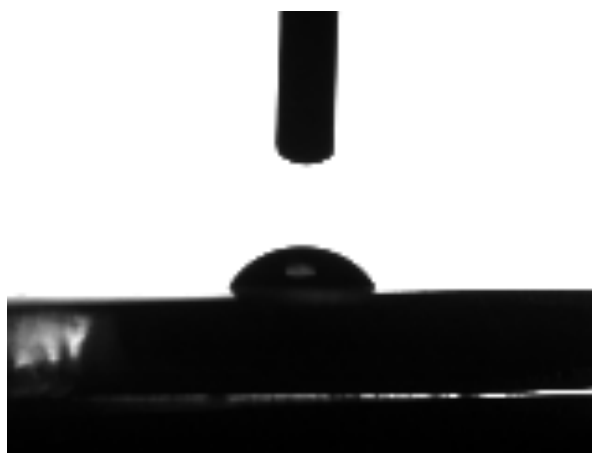
Dodecane contact angle: 58°
