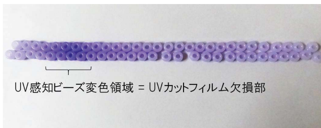
Figure 6 非破壊検査モデル実験 UV 感知ビーズ変色結果
