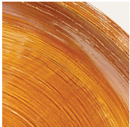
図18 塗装の剥げや割れが発生した千巻
