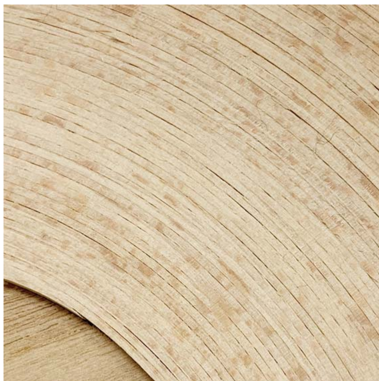
図3 巻き上げることによって反りを防止し木質が強化される
