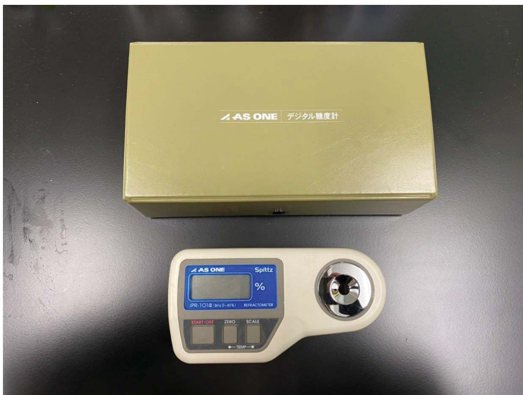
写真 2-13 搾汁液の糖度測定に用いた糖度計 (Spittz IPR-101α ASONE)
