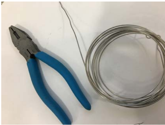
図7 補強用に用意した針金と形成するためのペンチ
