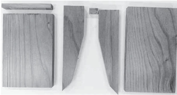
図1 各部品に切断した圧密化されたヒバ材
