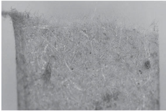
図12 未晒パルプの引張強度後の破断面
