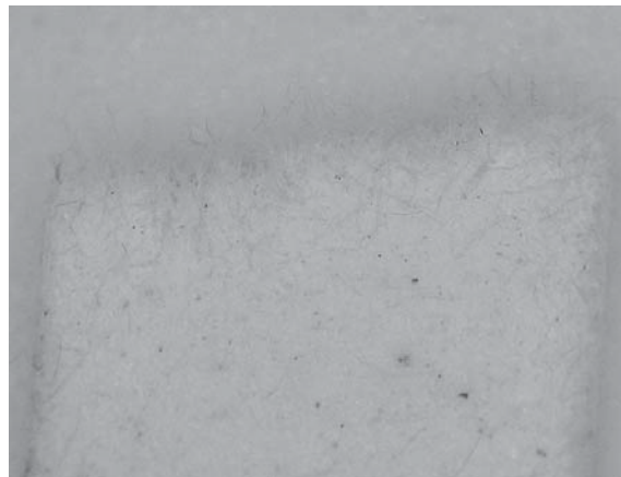
図13 晒パルプの引張強度後の破断面
