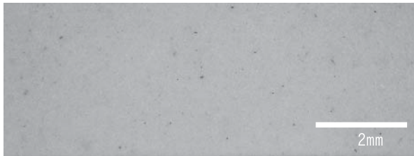
図7 晒パルプを原料とした紙の表面画像
