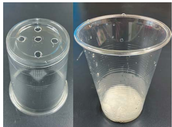
第8図. クリアカップb底面に排水溝を開け、水道水に浸したティッシュペーパーを詰める
