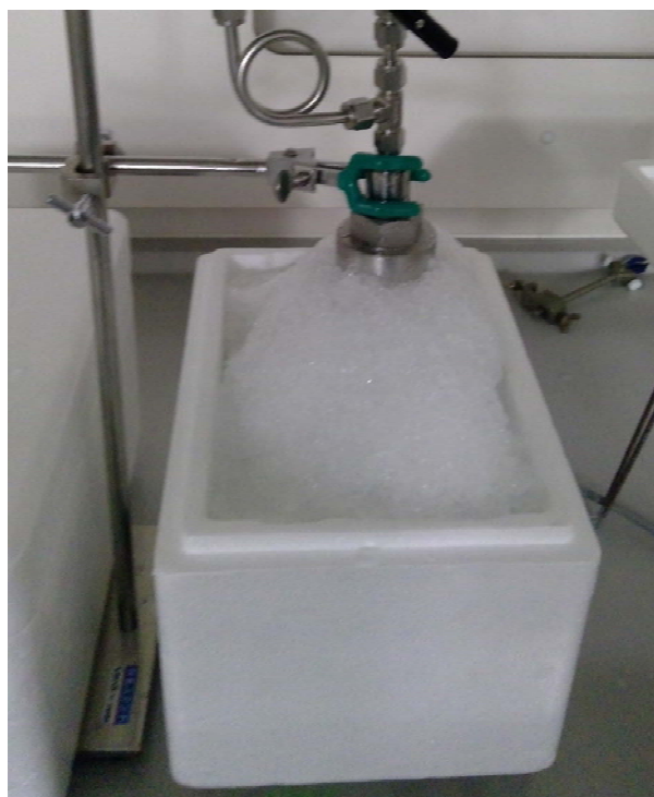
図 24.氷水を用いて 0℃に保って攪拌を行っている様子
