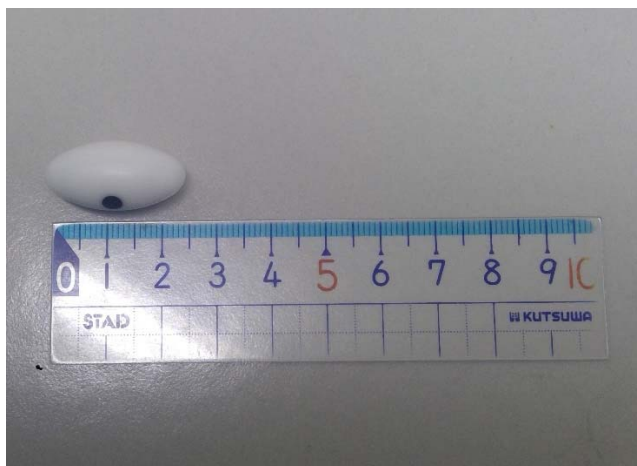
図 10. 攪拌時に用いたオーバル型の強力攪拌子. 横の長さが 25mm, 縦の長さ 12mm.
