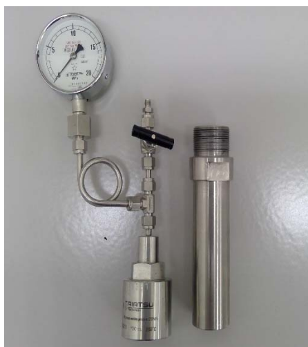
図 13.組み立てる前の圧力容器
