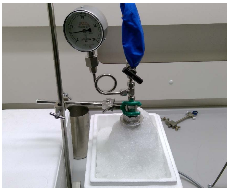
図 15.圧力容器を氷水に入れて、温度を 0℃に保っている様子
