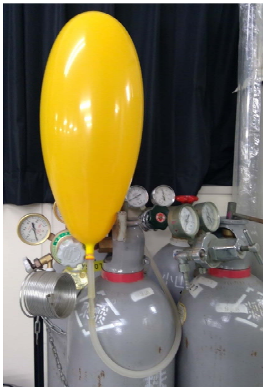
図 21.ゴム風船にガスボンベからメタンガスを入れている様子
