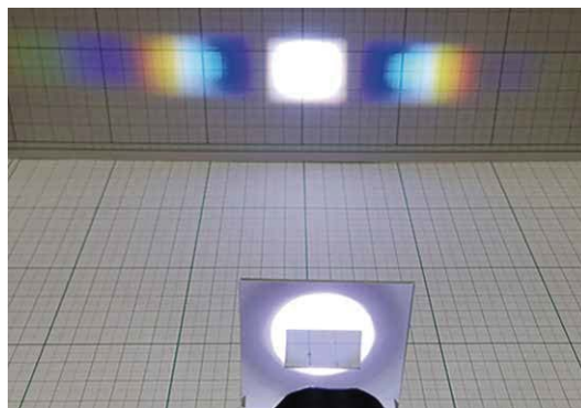
図3 回折格子による光回折(白色LED光源を使用)
