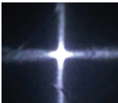
図1 布による光回折の様子（白色LED光源を使用）
