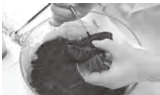
7 アクリル樹脂塗布による強化処理
