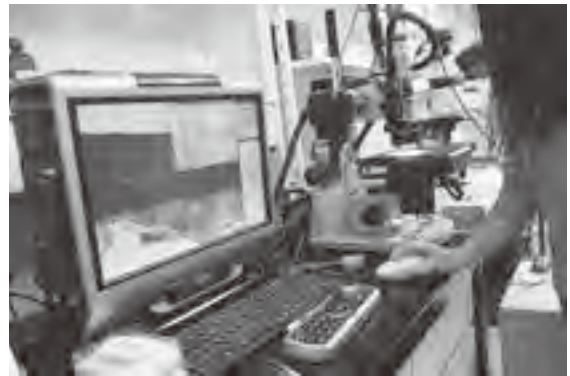
図12 デジタルマイクロスコープによる塗膜断面観察作業
