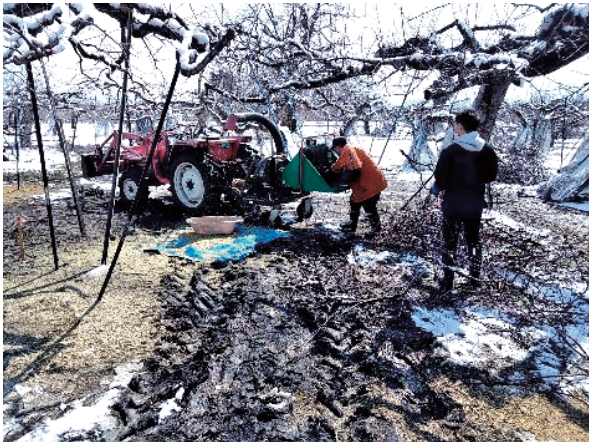
図1 りんご剪定枝のチップ化に用いた可動式チップパー
