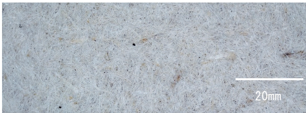
図8 楮の混合率0%の紙の表面
