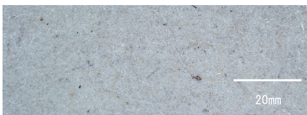
図12 抄紙機を用いて作製した紙の表面
