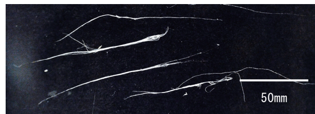
図7 晒パルプを原料とした紙の表面画像
