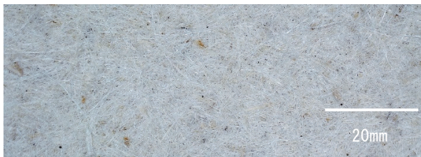
図10 楮の混合率60%の紙の表面
