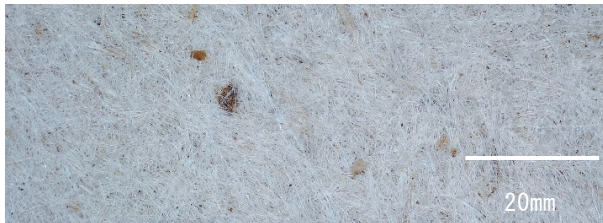
図9 楮の混合率20%の紙の表面
