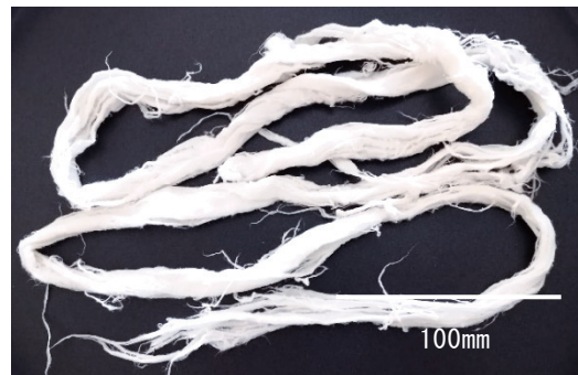
図6 未晒パルプを原料とした紙の表面画像
